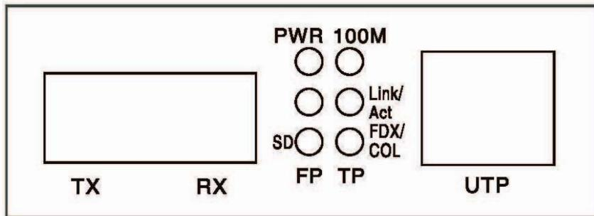
Abb. 2 Konverter Vorderseite für externe Stromversorgung
